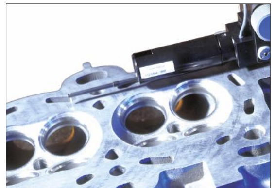
Snímač bez opěrky s vysokým rozlišením je nezbytný pro měření přímosti a vlnitosti povrchu.
