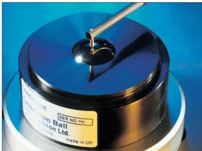
Kalibrace na kouli kontroluje stav hrotu, rozsah snímače, linearitu a funkce procesoru
